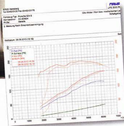
Das Leistungsdiagramm beweist es: Der Porsche 924 hat nach der Düsen-OP mehr Drehmoment zu bieten
