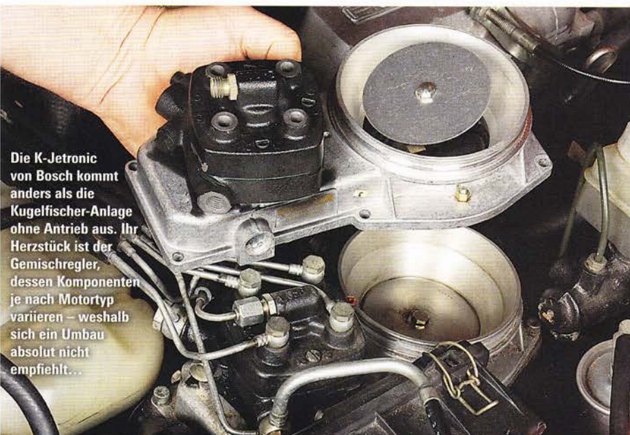
Nur was für Profis: Die K-Jetronic lässt sich mit solch einem unscheinbaren Einsatz im Lufttrichter an stark optimierte Motoren anpassen
