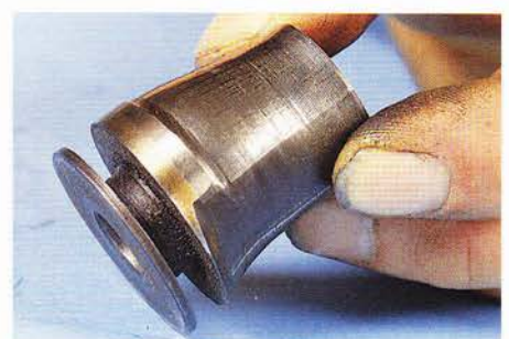
...feinmechanischen Systems ist der Raumnocken, über den die Einspritzmenge gesteuert wird
