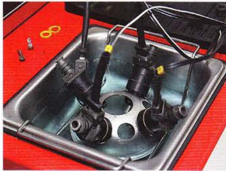
Anschließend kommen die vier Kandidaten ohne Filter, O-Ringe und Düsenkappen ins Ultraschallbad
