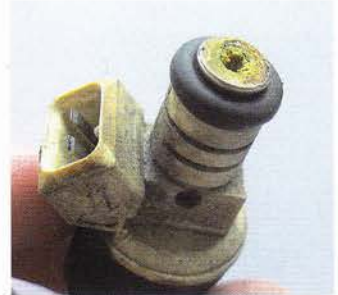
Elektronisch angesteuerte Einspritzventile öffnen und schließen bis zu 1500 Mal pro Minute – eine Dauerbelastung, die mitunter sichtbare Folgen hat
