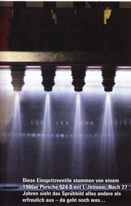
Geprüft werden Zerstäubung und Sprühverteilung; auch die Einspritzmenge lässt sich vergleichen
