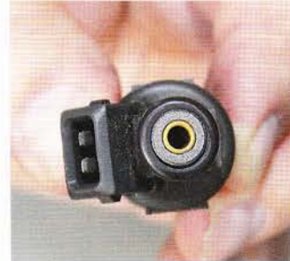
Elektronisch angesteuerte Einspritzventile öffnen und schließen bis zu 1500 Mal pro Minute – eine Dauerbelastung, die mitunter sichtbare Folgen hat
