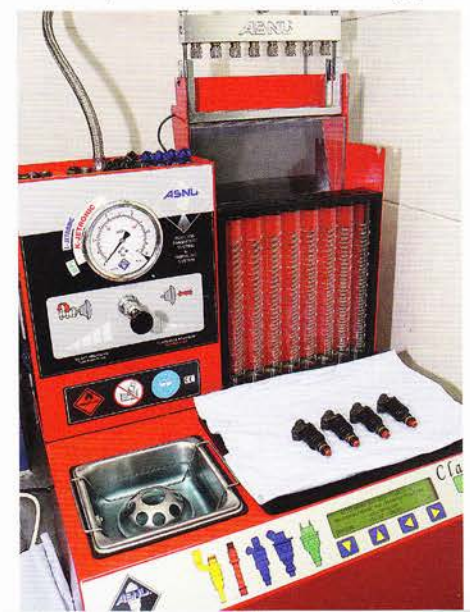
Ab auf den ASNU-Prüfstand: Hier werden die Einspritzventile auf Herz und Nieren geprüft
