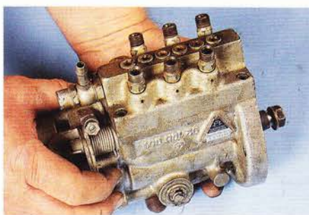
Vor allem aus Capri & Co bekannt: Die vom Motor angetriebene Kugelfischer-Anlage. Kern des...
