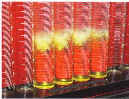
Geprüft werden Zerstäubung und Sprühverteilung; auch die Einspritzmenge lässt sich vergleichen
